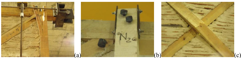
Figura 11: a) Colapso por abertura de fendas na ligações superiores da parede 1, b) chapas de aço nas ligações superiores e inferiores das paredes 2 e 3, c) modo de ruptura das paredes 2 e 3.
